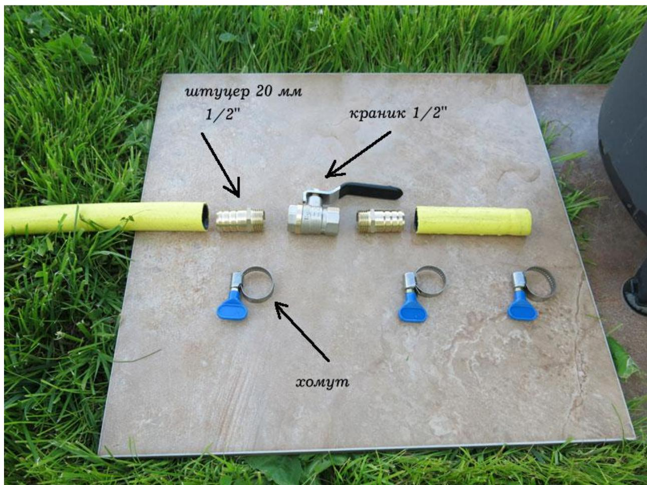
**3. На отводе воды из нагревателя используйте жесткий шланг внутренним диаметром не менее 20 мм, и длиной не более 10 м.**
