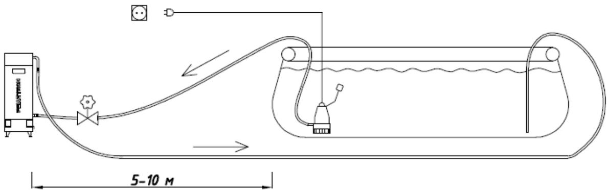
Схема установки нагревателя при подогреве полного бассейна в режиме циркуляции с использованием фильтр-насоса бассейна. При подключении нагревателя к шлангам диаметром 32 и 38 мм используйте переходники из комплекта нагревателя, длина отводящего шланга диаметром 20 мм должна быть менее 10 м.
