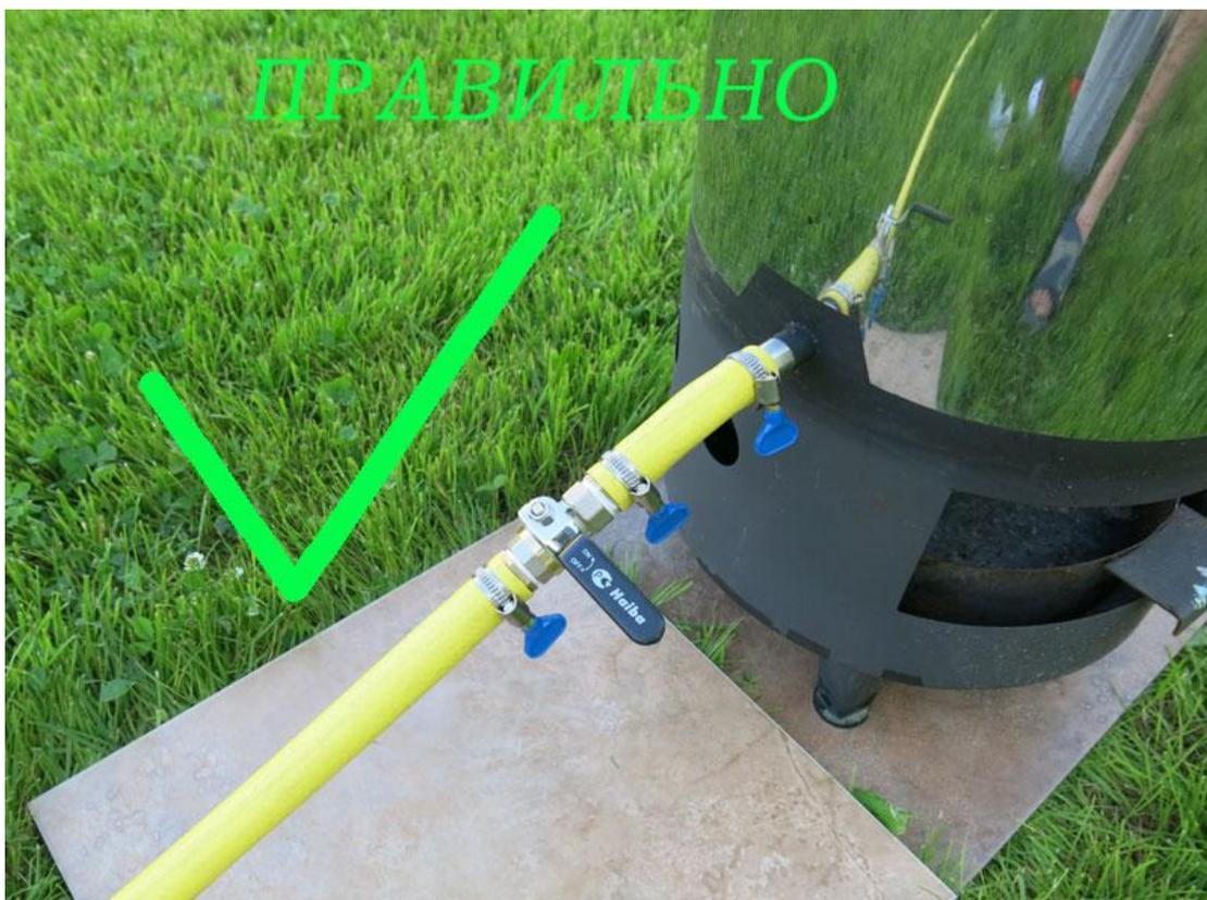
Для тех, кто не знает как поставить кран, следующее фото: нужны 2 штуцера 20 мм, 1/2 дюйма, 1 краник 1/2 дюйма, три хомута, а так же катушка фоторопластовой сантехнической ленты.
